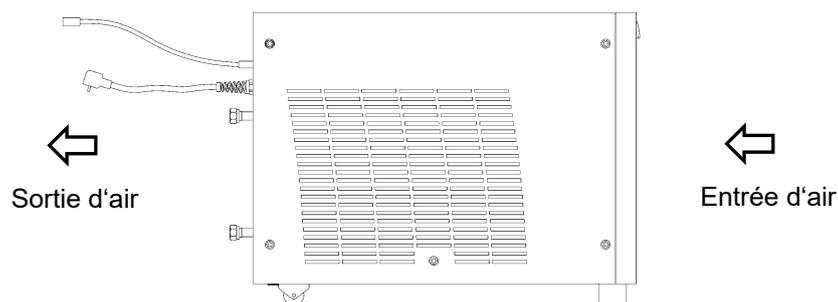
Le condensateur de la machine frigorifique est refroidi par air. L'air frais est aspiré par la grille frontale de l'appareil et envoyé vers l'arrière. Ainsi l'appareil doit être placé de telle façon à ce que la ventilation ne soit pas gênée. **Distance recommandée** : 50 cm au moins.
